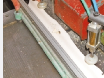
Bohren der Verzierungslöcher
